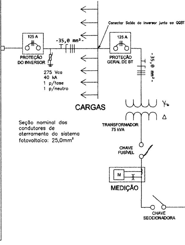
Seção nominal dos condutores de aterramento do sistema fotovoltaico: 25,0mm<sup>2</sup>
