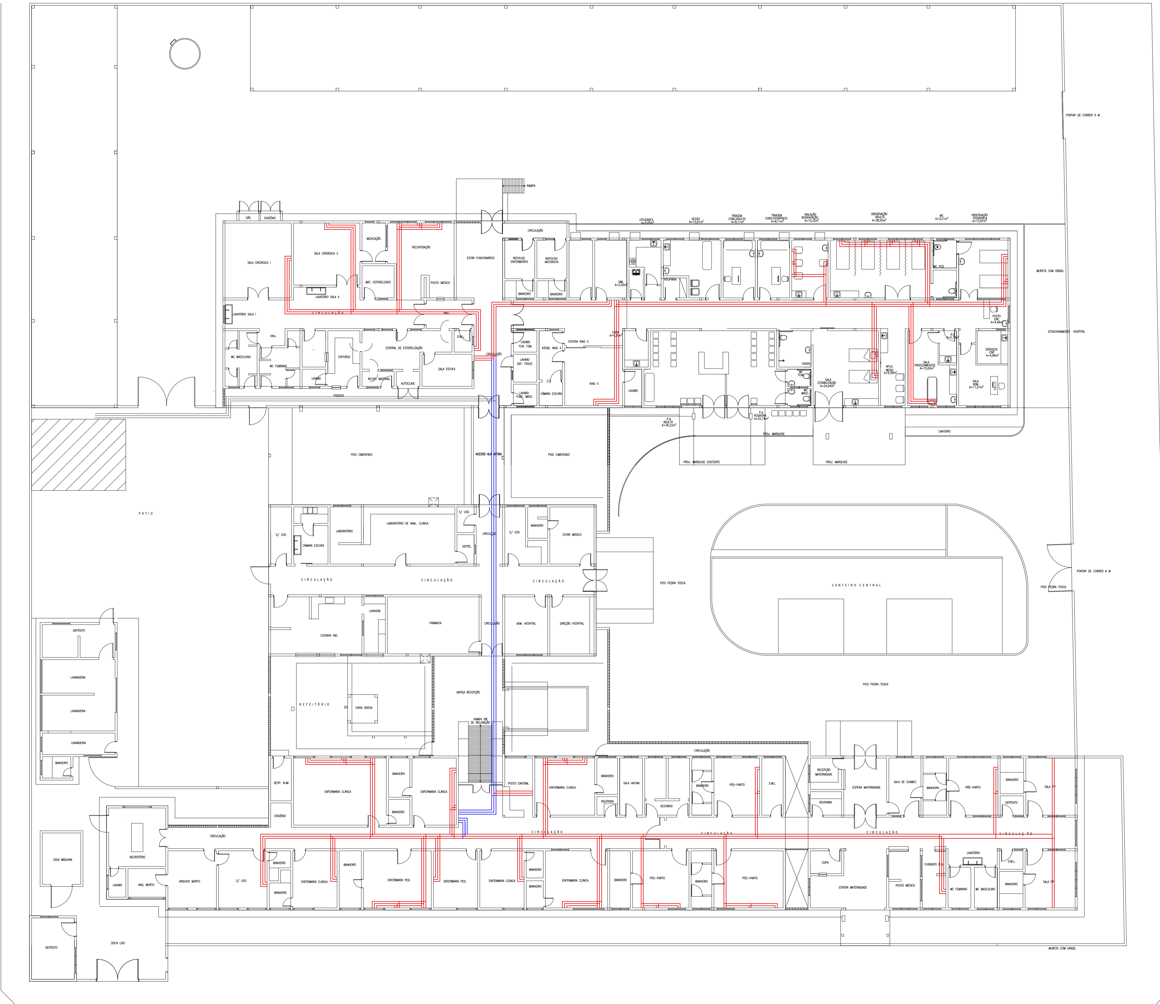
01 REDE DE GASES HOSPITAL ESCALA: 1/150
