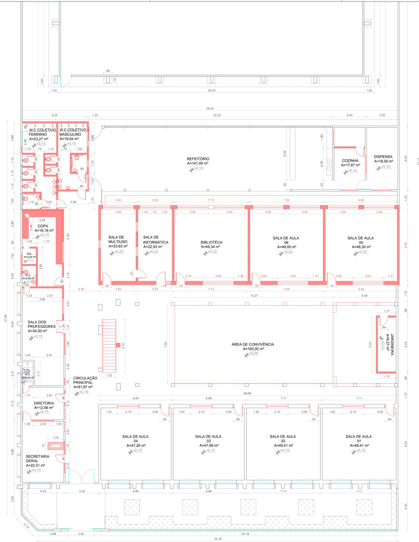
**01 PLANTA DE DEMOLIÇÃO PAV. TÉRREO**
