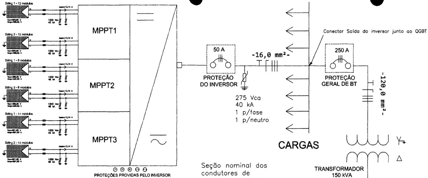
Seção nominal dos condutores de aterramento do sistema fotovoltaico: 95,0mm<sup>2</sup>
